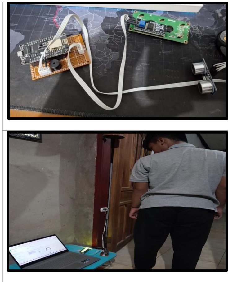
Gambar 5 Pemasangan kabel jumper dan pengujian alat
