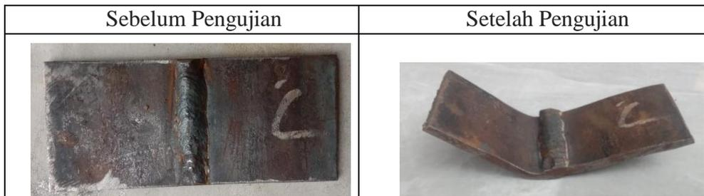
Gambar 5. Spesimen Laju 25 Liter/mnt Sebelum Dan Setelah Pengujian
