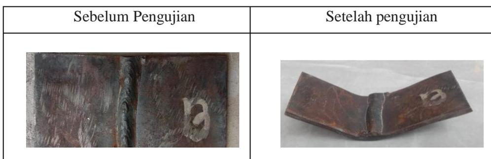
Gambar 4. Spesimen Laju 20 Liter/ mnt Sebelum Dan Setelah Pengujian
